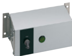
RMB-3HE-CE avec interrupteur à bascule et voyant (140 L x 76 P x 64 H mm)
