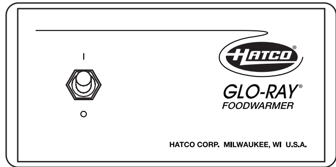
Panel de control con interruptor de I/O de dos posiciones.
